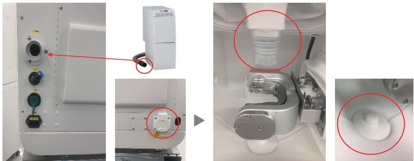
**⑤AC 電源ケーブル、LAN ケーブル接続と加工機車輪の固定**
