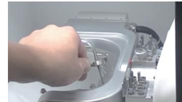
2, 「⑧」 T.C.S（ツールチェックセンサー）が適切に動作するか確認
