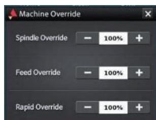
「Spindle Override」：スピンドルの回転速度を調整
