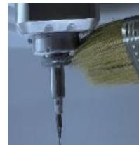
集塵機の性能が低下している場合、集塵機のフィルターを掃除、又は、交換をすること
