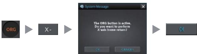
ORGが押されている状態でX-/Y+/Z+/A-/B-を押すと、原点に移動する
