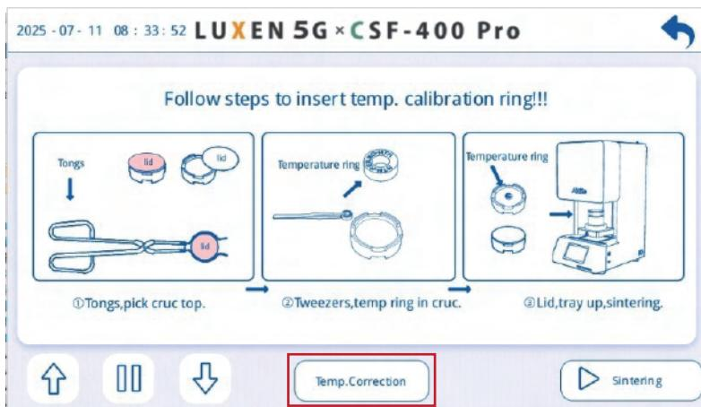
⑤ 「Measured」の部分に確認したキャリブレーション焼成温度を入力し「Temp.Correction.」をタップする
