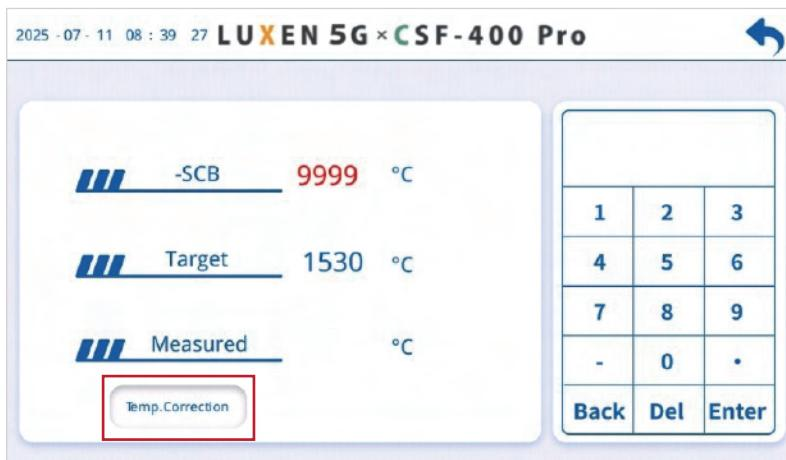
\* ⑤ で入力した「Measured」の数値が 1520~1540°C になってない場合は、必ず再キャリブレーションして焼成温度を設定する必要があり、この作業をせずに実際の焼成を行うと焼成が失敗する可能性が非常に高くなる
