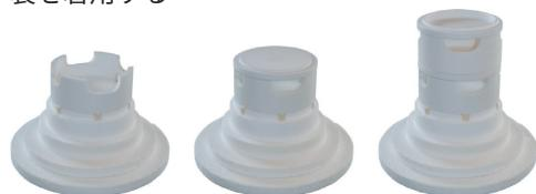
① 断熱テーブルの上に焼成リングを置く
