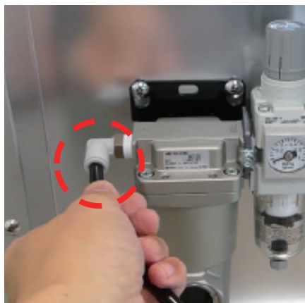
8. コンプレッサーからのエアホースを 引き出しの後ろ面に連結する
