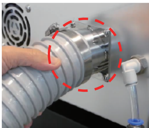
7. 集塵機の管を連結する ( 外径Φ60mm/ 内径Φ56mm)
