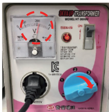
11. 電源ケーブルを変圧器に繋げて、220V 程になるか確認 足りない場合、青いバルブを1から4まで回し、電圧を上げる
