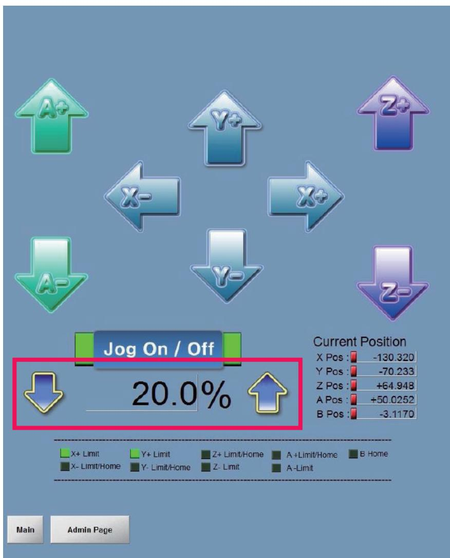
各軸を手動で操作できるページ / 画面の矢印を押して、またはキーボードで各軸を操作できる
