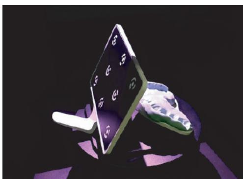
1. 「ターゲットバイトを載せる」：スキャンプラットフォームの上に、写真の様にターゲットバイトを乗せる
